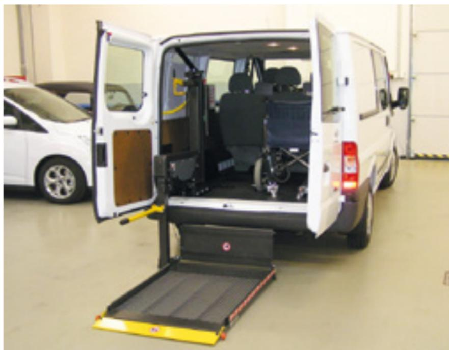
La DH-PH1 è una **sponda lineare ad 1 braccio di sollevamento**, adatta per il montaggio sulle porte posteriori o laterali di un'ampia serie di pullman, bus di medie dimensioni e ambulanze.
